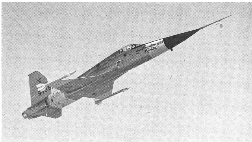
Der einsitzige Abfangjäger Northrop N-156 F «Freedom Fighter» (= «Freiheitsjäger»). Bewaffnung als Fangjäger: An jedem Flügelende ein Infrarot-Sidewinder-Zielsuchgeschöß sowie deren zwei an einem Reck unter dem Rumpf.
