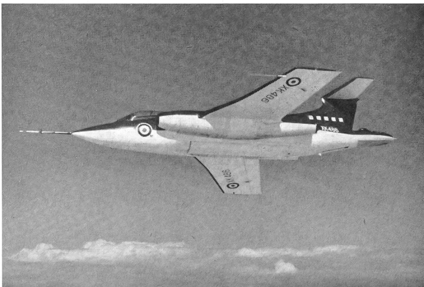
Blackburn N.A.39 «Buccaneer», Tiefangriffsflugzeug. — Bewaffnung: Nukleare und konventionelle Waffen in Bombenschacht. — Das Ziel des N.A.-39-Entwurfes: Hohe Fluggeschwindigkeit in extrem niedrigen Flughöhen. Staffeleinsatz dieses Typs: 1962.
