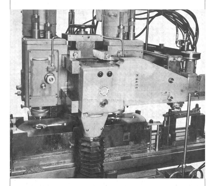
Gleichzeitiges Kopierfräsen von beiden Hälften eines Pleuelstangen-Gesenkes auf STARR-Hydrokopier-GESENK-FRÄSAUTOMAT
