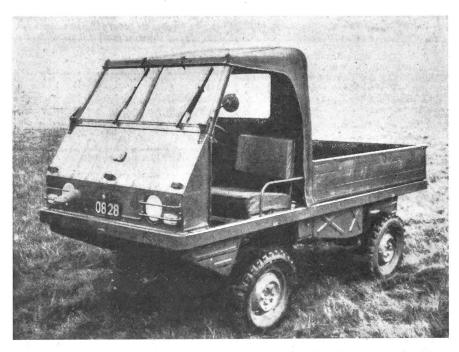
Gegenwärtig werden in unserer Armee zwei neue Gefechtsfeld-Fahrzeuge erprobt. Unser Bild zeigt das Fahrzeug der österreichischen Firmen Steyr-Puch. Es ist ausgerüstet mit einem Zweizylinder-Boxermotor von 22 PS und einem Fünfganggetriebe. Dieses Fahrzeug mit vier Sitzplätzen, wovon zwei versenkt werden können, kann auch für den zivilen Bedarf verwendet werden.
