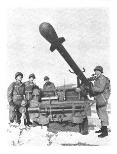
Eine von der amerikanischen Armee entwickelte Abschußvorrichtung für Kurzstrekkenraketen vom Typ «Davy Crockett», einer taktischen Raketenwaffe, die mit schwachen Atomsprengköpfen ausgerüstet werden kann und für Panzer- und Infanterieverbände vorgesehen ist, wird nach einer Mitteilung der USA-Armee noch in diesem Sommer Truppe ausgeliefert werden.
