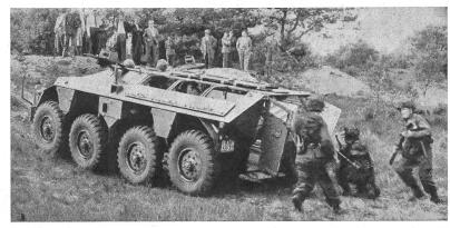
DAF Schützenpanzerwagen Typ YP 408 Gewicht: zirka 9000 kg — Abmessungen: 6 x 2,4 x 1,8 — Geschwindigkeit: 2-90 km/h Besatzung: 12 Mann
