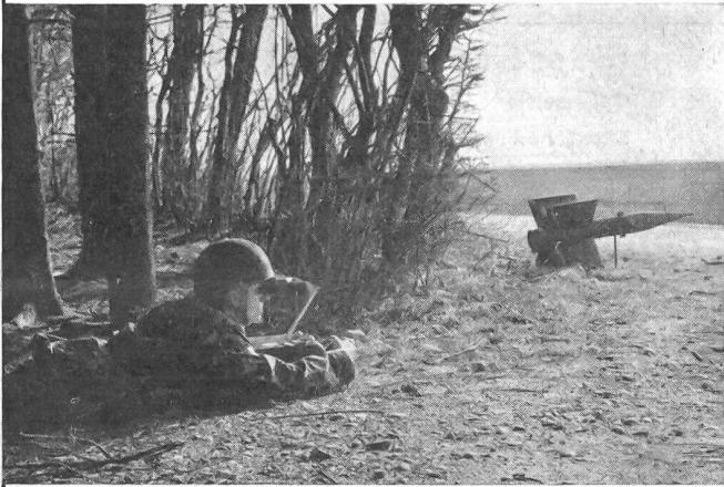
Die MOSQUITO wird ohne Abschussgestell direkt vom Boden gestartet, und der Schütze lenkt sie mittels eines Lenkknüppels über elektrische Signaldrähte ins Ziel. Für Übungsschlägen wird der Kriegskopf durch einen Übungs-Fallschirmkopf ersetzt, womit die Rakete nach erfolgtem Fluge zurückgewonnen werden kann.
