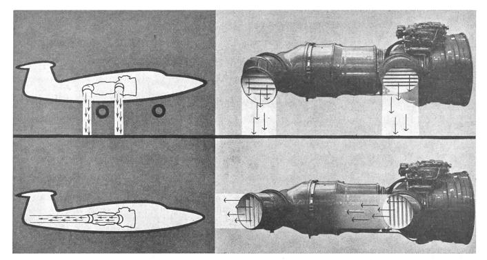
Links: Schematische Darstellung der Gasstrahlablenkung durch die schwenkbaren Triebwerk-Strahldüsen. – Oben der Schwebeflug (Senkrechtflug) mit abwärtsgeschwenkten Düsen; unten der Geradeausflug (Horizontalflug) mit rückwärtsgeschwenkten Düsen.
