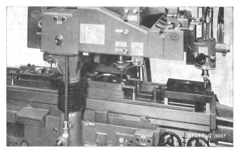
auf STARR-Hydrokopier-Fräsmaschine KA-200/2
