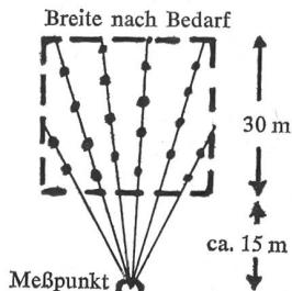
Minendichte: pro 1 m Nestbreite bei 30 m Tiefe = 2 Panzerminen.
