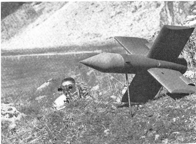
Die Moskito in Schußstellung. Unser Bild zeigt die abschußbereite Rakete, die von einem Schützen (Hintergrund) über ein Drahtkabel, welches sich beim Abschuß absplitt, bis ins Ziel gesteuert werden kann.
