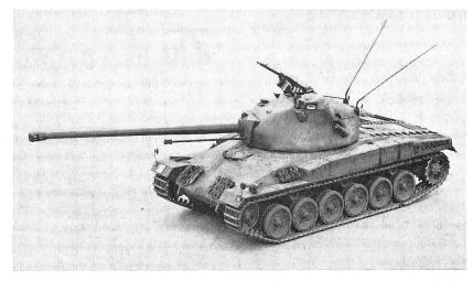
Der Pz. 58. Die beiden sichtbaren Antennen weisen darauf hin, daß der Panzer auch über eine moderne Sende- und Empfangsanlage, über Bordverständigung und ein Außenbordtelephon verfügt
