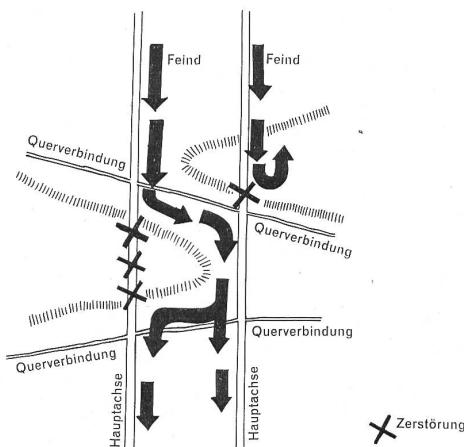
Wenn Querverbindungen zwischen den Achsen nicht zerstört werden, besteht die Gefahr, daß die Zerstörungen an den Achsen umfahren werden können.
