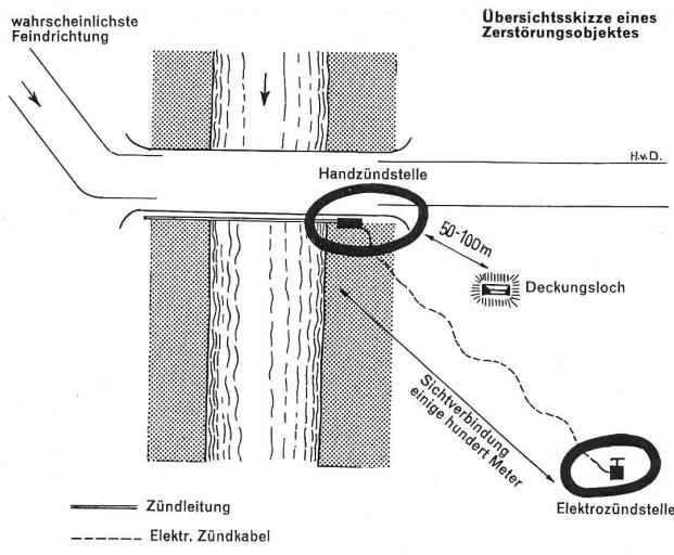
Da an der Handzündstelle nur mit kurzer Zündschnur gearbeitet wird, muß in der Nähe der Sprengstelle ein tiefes, schmales Deckungslöch für 2 Mann ausgehoben werden, wo der «Zerstörer» und der Wachposten vor den herumfliegenden Trümmern Deckung finden.
