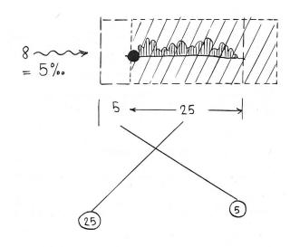
2. Da der Querwind bei Windstärke 8 auf 1 km Entfernung das ganze Flächenfeuer um 5 ‰ nach rt. verschiebt, muß eine ent-sprechende Korrektur nach lk. erfolgen. Auf die Lafette (Streu-feuerwalzen) umgedacht: 10 rt., 20 lk.
