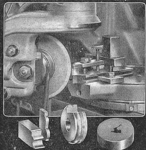
zum Schleifen von Profil-Lehnen, flachen und runden Profilstählen, mehrleiligen Matrizen usw.
