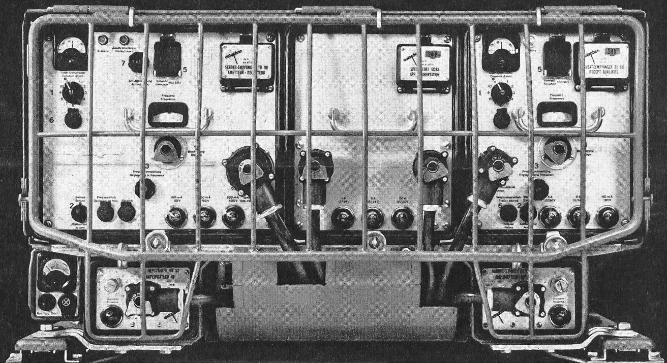
Die Funkstation SE 407, von der Autophon AG für die Schweizer Armee entwickelt, ist für den Einsatz in Panzern, Kdo-Fahrzeugen, Werkstattwagen usw. gebaut. Sender-Empfänger und Zusatzempfänger sind je für mehr als 100 Kanäle ausgerüstet, von denen sich mehrere vorabstimmen und über das Bedienungsgerät fernauswählen lassen. Speisung aus der Fahrzeubatterie. Die Anlage ist robust und betriebssicher konzipiert, sie wird im Wechsel- oder Gegensprechverkehr und als Relaisstation eingesetzt.
