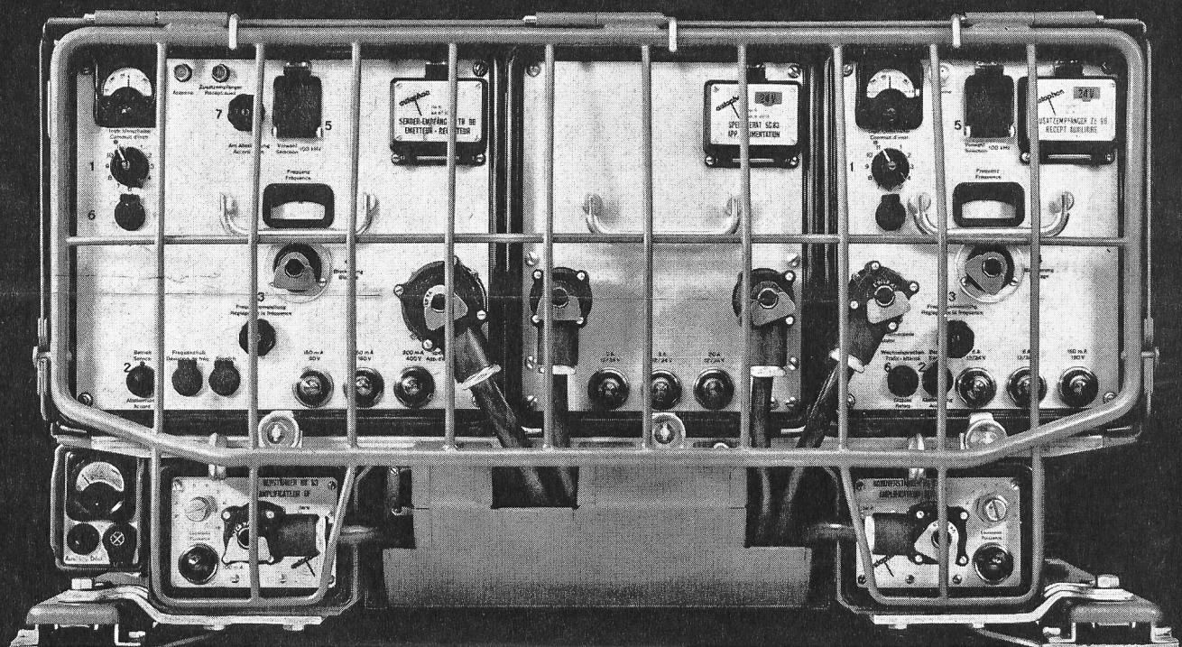
Die Funkstation SE 407, von der Autophon AG für die Schweizer Armee entwickelt, ist für den Einsatz in Panzern, Kdo-Fahrzeugen, Werkstattwagen usw. gebaut. Sender-Empfänger und Zusatzempfänger sind je für mehr als 100 Kanäle ausgerüstet, von denen sich mehrere vorabstimmen und über das Bedienungsgerät fernauswählen lassen. Speisung aus der Fahrzeughbatterie. Die Anlage ist robust und betriebssicher konzipiert, sie wird im Wechsel- oder Gegensprechverkehr und als Relaisstation eingesetzt.
