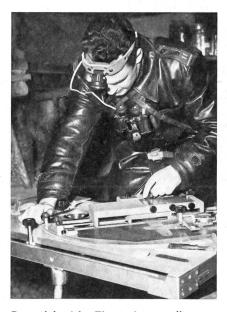
Der erfolgreiche Einsatz ist vor allem von der Schnelligkeit abhängig, mit der die Meldungen durchgehen und die Schießelemente errechnet werden. Dieser von einem Offizier bediente Schießelemente Rechner in der Feuerleitstelle eines Artillerieregiments läßt die für die Weitergabe an die Geschütze notwendigen Zahlen innert weniger Sekunden errechnen
