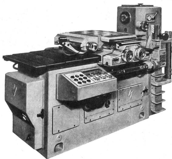
sowie **Hydr. Fräsmaschinen**
