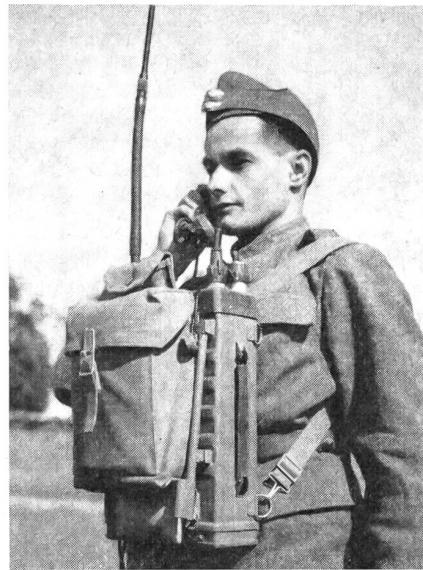
Die Schweizer Armee wird mit einem frequenzmodulierenden Kleinfunkgerät SE 206—209 ausgerüstet, das als Verbindungsmittel auf kürzere Distanzen (5 bis 20 Kilometer) sämtlichen Waffengattungen gute Dienste leisten wird. Das 11,3 Kilo schwere Gerät ist tragbar und kann mit einem Zusatzerät als stationäre Anlage auf einem Jeep verwendet werden.
