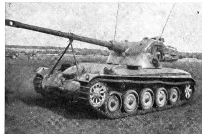
Auf dem Kampfwagen können 36 Schuß 7,5-cm-Munition, 2100 Schuß MG-Munition sowie HG und MP mitgeführt werden. Beim Schießen werden die 7,5-cm-Hülsen automatisch aus dem Panzer geworfen. Das Richten erfolgt hydraulisch oder mechanisch mittels eines Zielfernrohrs.
