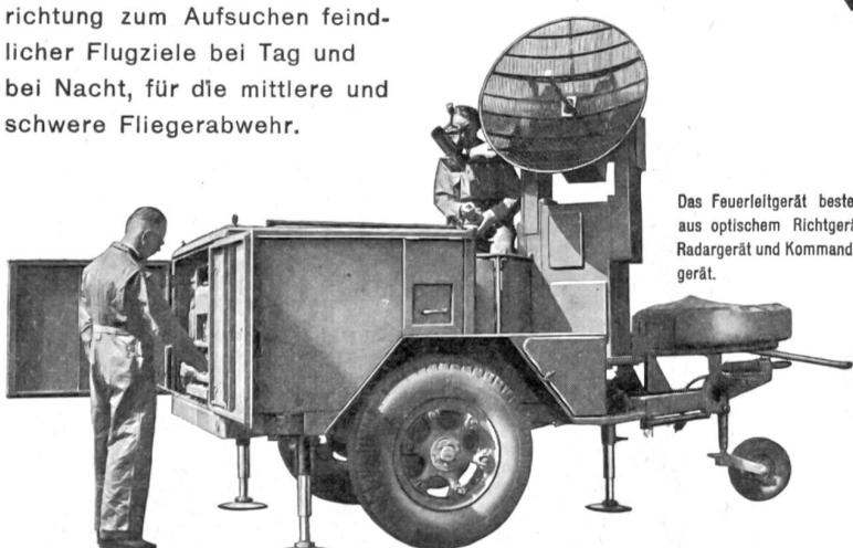
Das Feuerleitgerät besteht aus optischem Richtgerät, Radargerät und Kommandogerät.
