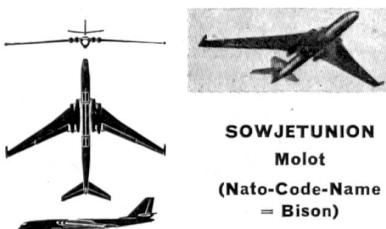
Der Bison, ein viermotoriger schwerer Düsenbomber, dürfte in den Leistungen der amerikanischen B-52 ebenbürtig sein. **Erkennungsmerkmale:** Hochdecker mit negativer V-Stellung, sehr schlanke, gepfeilte Flügel, ebenso das Höhensteuer — trapezförmiges, eckiges Seitensteuer, leicht gepfeilt — Flügelhinterkanten im Bereich der Triebwerke verlaufen rechtwinklig zum Rumpf — langer, schlangenförmiger Rumpf mit eingebauter Kabine.
