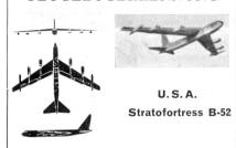
Die Strahlturbinen sind paarweise in Gondeln an nach vorne ragenden Trägern unterhalb der Flügel angebracht. Der erste Träger befindet sich in einem Abstand von 10,50 m, der zweite in 19 m von der Rumpflängenachse entfernt. Durch die hohen Gewichte der beiden Triebwerke (über 5 t pro Gondel) sind Flügelschwingungen nahezu ausgeschlossen. Strömungstechnisch erfüllen die Träger eine analoge Funktion, wie die Grenzschichtzäune bei den heutigen modernen Flugzeugen.
