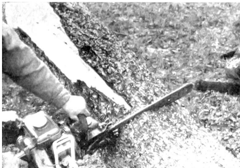
Ein-Mann-Motorsäge für die Holzgewinnung.
