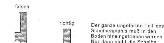
Der ganze ungefärbte Teil des Scheibenpfahls muß in den Boden hineingetrieben werden. Nur dann steht die Scheibe fest genug, daß sie bei einem Treffer sicher fällt.
