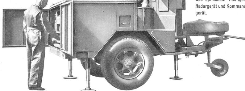
Das Feuerleitgerät besteht aus optischem Richtgerät, Radargerät und Kommandogerät.
