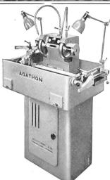
Präzisions-Schleif- und Läppmaschinen für
