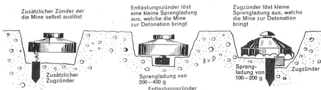
Die hauptsächlichsten Sprengfallentypen
