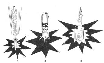
1 Schlagzünder (spricht auf Zug oder Druck an). Ausgesprochener Minenzünder. Auslösen und Vortreiben eines Zündstifts vermittelst Federkraft. Anschlagen einer Zündpille. Explosion der Sprengkapsel und Detonation der Mine. (Schweizerische Gegenstücke: Streuminen-Zünder, Sprengkisten-Zünder, Pfahlminen-Zünder, Schlag-Zünder, für Sprengladungen).
