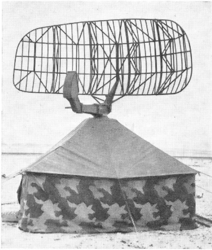
Unsere Flab TPS-1-E-Suchradargerät mit einer Reichweite bis zu 160 km. ATP
