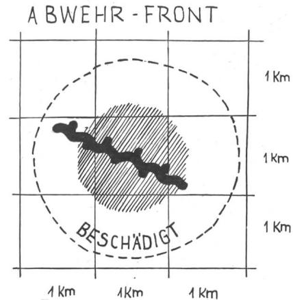
Stacheldrahtverhau werden bei 20 KT bis rund 600 m vom Nullpunkt völlig zerstört und bis 1500 m beschädigt.
