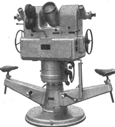
für hochpräzise Vermessungen von Flugbahnen
