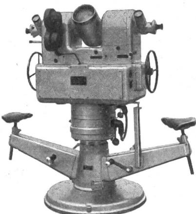
für hochpräzise Vermessungen von Flugbahnen
