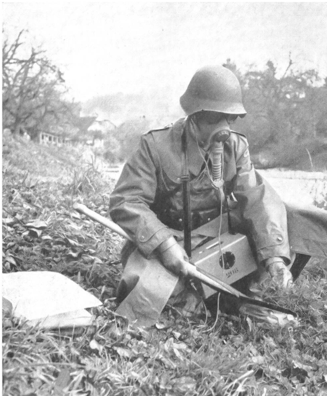
Mit einem speziellen Meßgerät spüren die Spürer der A-Equipen nach radioaktiven Spaltprodukten und entnehmen Proben zur genauen Untersuchung im A-Laboratorium.
