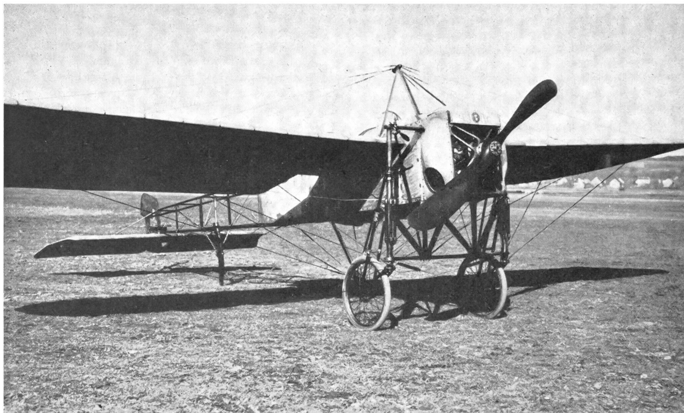
Blériot-Eindecker mit 80-PS-Gnôme-Rotationsmotor. Es handelt sich hier um das Flugzeugmuster, mit dem Bider seinerzeit seine Alpenüberquerung ausführte.
