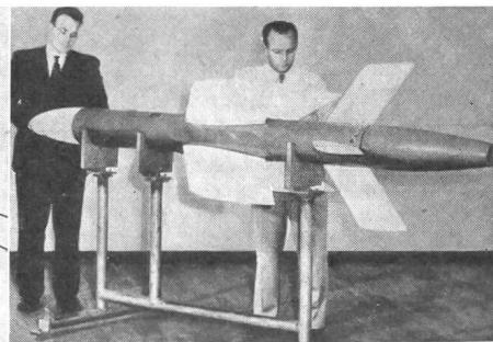
Die Genauigkeit sowohl der V 1 als auch der V 2 war ziemlich gering. Man sucht sie indessen zu verbessern, indem man den Roboter während des Fluges zu steuern sucht, z.B. durch drahtlose Impulse von Bodenstationen aus, wie hier, oder auf andere Art . . .
