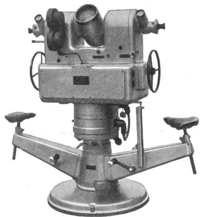
für hochpräzise Vermessungen von Flugbahnen
