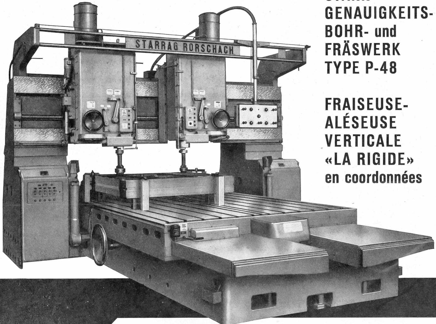
Werkzeugmaschine zur vorteilhaften Bearbeitung großer, flacher Werkstücke mit **KOORDINATENEINSTELLUNG** der Spindelkasten und des Tisches mittels **Präzisions-Maßstäben** und **Ableseoptik**.
