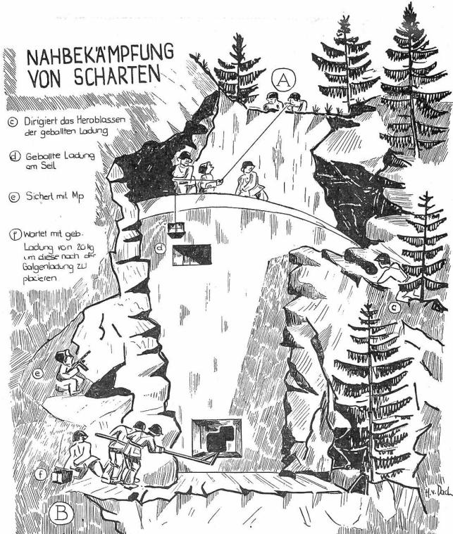
A SPRENGTRUPP LASST MIT HILFE EINES SEILS EINE GEBALLTE LADUNG VOR DIE SCHARTE (Maximales praktisches Sprengstoffgewicht : 20 Kg)
