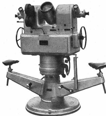
für hochpräzise Vermessungen von Flugbahnen
