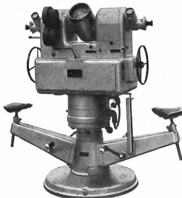
für hochpräzise Vermessungen von Flugbahnen
