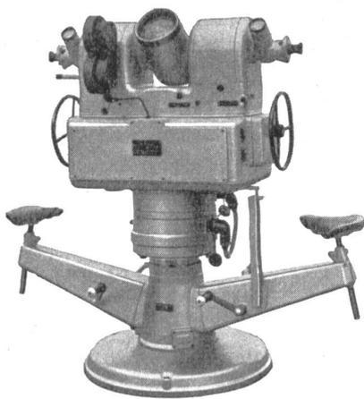
für hochpräzise Vermessungen von Flugbahnen
