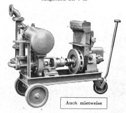
Leistungen 1 bis 500 1/s. Kein Bodenventil Keine Klappe im Saugstutzen. Keine Hilfs-Vakuumpumpe. Jederzeitiges automatisches Ansaugen auch nach Lufteintritt im Saugrohr. Keine reibenden, sich abnützenden Dichtungsflächen, daher störungsfrei auch bei Schlamm-, Sand- und Kiesförderung.
