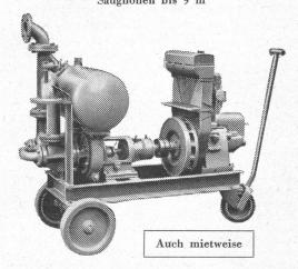
Leistungen 1 bis 500 l/s. Kein Bodenventil. Keine Klappe im Saugstutzen. Keine Hilfs-Vakuumpumpe. Jederzeitiges automatisches Ansaugen auch nach Lufteintritt im Saugrohr. Keine reibenden, sich abnützenden Dichtungsflächen, daher störungsfrei auch bei Schlamm., Sand- und Kiesförderung.
