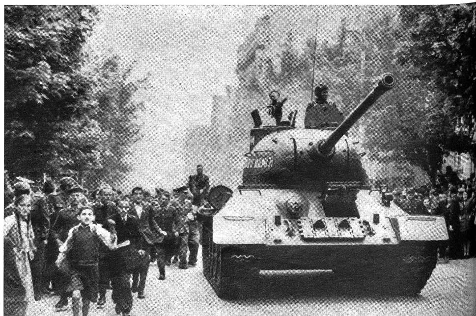
Prototyp des ersten jugoslawischen Panzers aus einer Fabrik in der Nähe Belgrads. Sein Gewicht liegt zwischen 35 und 40 Tonnen, während seine Kanone ein Kaliber von 70 bis 80 mm haben dürfte. Der Panzertyp, der dem russischen T-34 nicht unähnlich ist, wird von Fachleuten für die Bedürfnisse Jugoslawiens als günstig bezeichnet.
