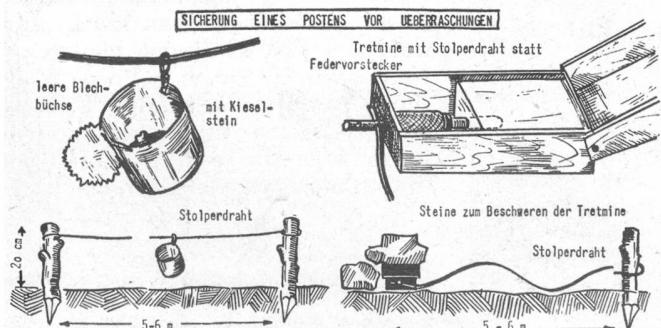
— Umgeb die Wache mit einem Draht auf ca. 20 cm Höhe, an dem Glöckchen oder leere Blechbüchsen mit einem Kieselstein hängen.
