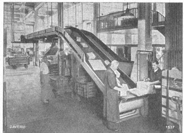
Teilansicht einer Paketförderanlage
