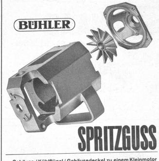
Gehäuse / Kühlflügel / Gehäusedeckel zu einem Kleinmotor aus Aluminium-Spritzguss. Im Gehäuse ist das Statorpaket direkt eingegossen. Alle drei Stücke werden gleichzeitig in einem Arbeitsgang und in einer
