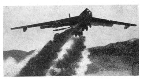
Düsenbomber als Atombombenträger mit Raketenstart.
