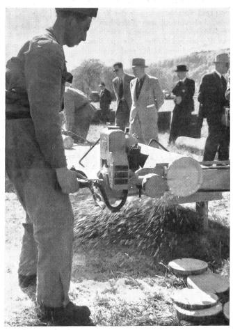
Sägemaschine für Sappeure.
