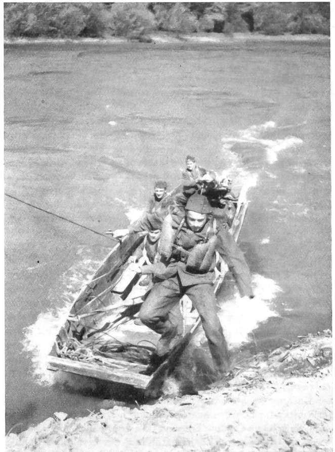
Uebersetzen von Truppen in Schlauch-Uebersetz- und Sturmbooten. Die Sturmboote sind mit einem 4-Zylinder-Kovats-Außenbormotor (35 PS) ausgerüstet. (ATP Bilderdienst Zürich)
