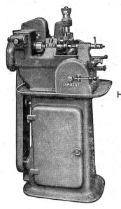
Halbautomatische Abwälzräderfräsmaschine Nr. 1 Type 75
