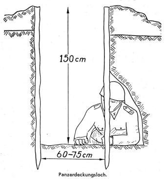
nur dort zu empfehlen, wo ein ausreichender Flankenschutz sichergestellt ist. Kommt dieses Kampfverfahren zur Anwendung, wird z.B. in deckungslosen Geländeabschnitten die Anlage sogenannter Panzerlöcher (siehe Bild) zur ersten Aufgabe.
