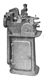
Halbautomatische Abwälzräderfräsmaschine Nr. 1 Type 75
