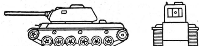
Infanteriepanzer. Abgeflachter Panzerkörper. Hoher und relativ schmaler Turm, der bei neuen Modellen stromlinienförmig ist. Der Turm ist weit nach vorn verschoben. Breite Raupenketten.
