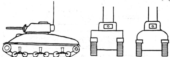
Hoher Panzerkörper mit rundlichen Formen. Niedriger, gerundeter Turm, etwas vor die Mitte nach vorn versetzt. Funkanlage, bestehend aus zwei Antennen, zuhinterst im Turm. Die Raupenkette wird oben durch den Panzerkörper geschützt.
