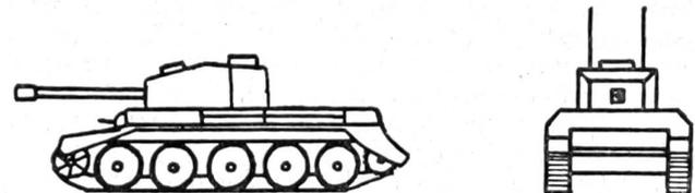
Schwerpanzer (Kreuzer). Abgeflachter, auf den Seiten abgeschrägter Panzerkörper. Niedriger und sehr breiter Turm über die Mitte nach vorn gebaut. Funkausrüstung wie im Infanteriepanzer.
