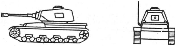
Relativ großer, hinter der Mitte placierter Turm. Verstärkte Fassung des Kanonenrohrs. Mündungsbremse. Besondere Beobachtungskuppel. Die Antenne ist am Panzerkörper montiert, in der Regel rechts. Bei den meisten Modellen Vorderradantrieb.
