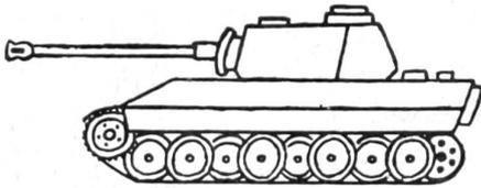
Oben: Abgeflachter Panzerkörper. Unten: Niedriger Panzerkörper. Große, doppelreihig angeordnete Laufräder («Tiger», «Panther» und «Königstiger»).
